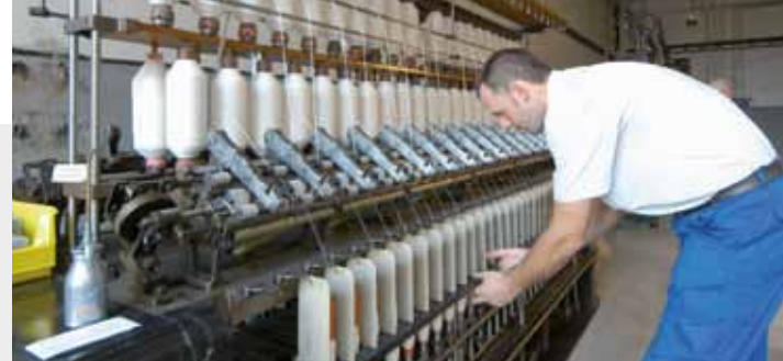
Ein Restaurator wartet die Ringspinnmaschine
